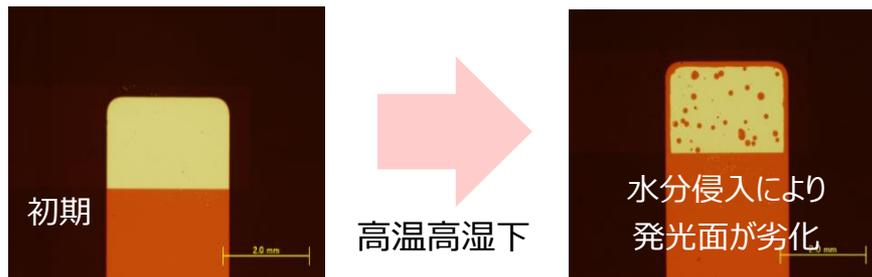
@有機ELデバイスでの劣化（性能）評価
