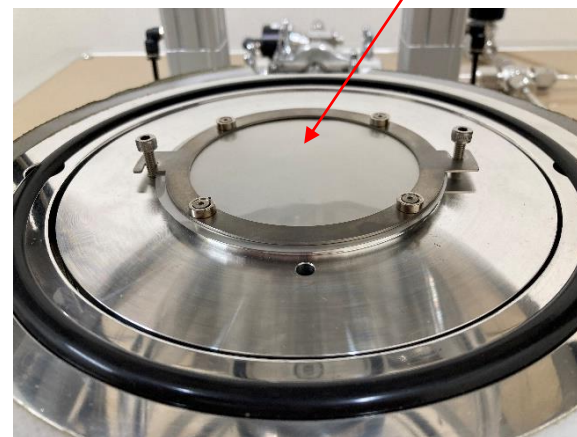
校正用フィルムをセットした測定装置
