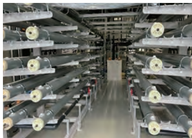
UF膜装置で液肥を濃縮
