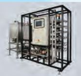
UF/RO膜廃水処理装置
