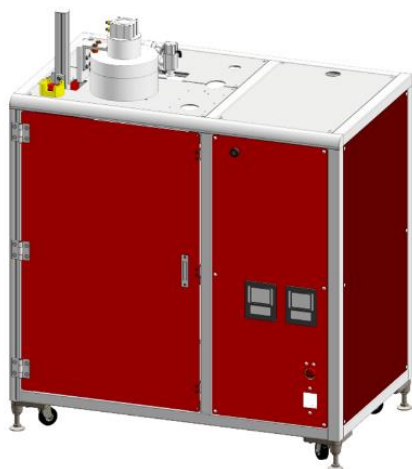
新たに開発したガス・水蒸気透過度測定装置 (MORESCO-SuperDetect C-S1)
